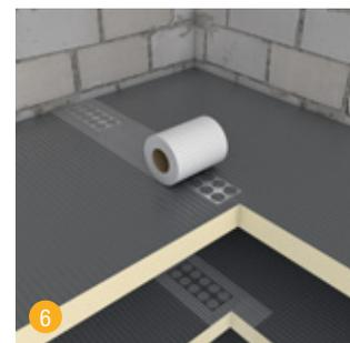
6 La pose du carrelage peut être réalisée directement après le renforcement des arêtes du bord à souder.
