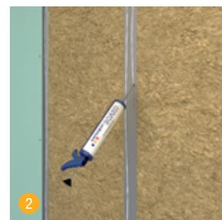
2 Le mastic d'étanchéité et colle hybride swissporBOARD SB 911 permet de coller les panneaux de construction swissporBOARD sur n'importe quelle ossature.
