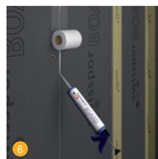
6 Fixer les joints des panneaux de construction avec la bande de renfort SK swissporBOARD (autocollante). Dans les zones humides, étanchéifier avec la bande d'étanchéité spéciale swissporBOARD et avec les mastics flexibles swissporBOARD 1K / Turbo 2K.
