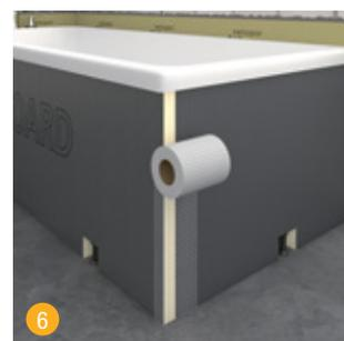
6 Recouvrir l'ensemble des angles à l'aide de la bande d'armature SK autocollante.
