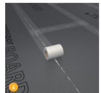
4 Doter toutes les arêtes du bord à souder avec la bande de renfort SK swissporBOARD (autocollante). Dans les zones humides, étanchéifier avec la bande d'étanchéité spéciale swissporBOARD et avec les mastics flexibles swissporBOARD 1K / Turbo 2K.
