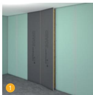
1 Pour la transition avec les plaques de plâtre cartonnées, appliquer des plaques de construction swissporBOARD.
