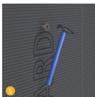
5 Installer des vis pour isolant swissporBOARD à travers les trous pré-percés dans les bouchons de mortier et les enfoncer entièrement après le durcissement.
