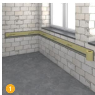
1 Appliquer la bande d'étanchéité pour bord de baignoire swissporBOARD sur le mur avec la colle flexible S1 swissporBOARD à la hauteur de la baignoire.
