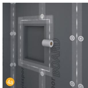
4a Doter toutes les arêtes du bord à souder avec la bande de renfort SK swissporBOARD (autocollante).
