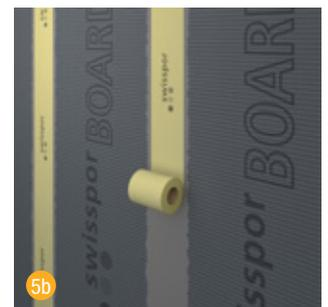
5b La bande d'étanchéité swissporBOARD scelle les joints pour les zones humides et s'applique avec le mastic flexible 1K rapide swissporBOARD / mastic flexible Turbo 2K.
