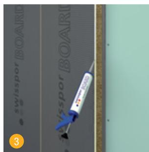
3 Coller et sceller également les arêtes du bord à souder les uns aux autres à l'aide du mastic d'étanchéité et colle hybride swissporBOARD SB 911.
