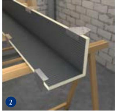
Position der swissporBOARD Montageanker ausmessen und am swissporBOARD Winkelement befestigen.
